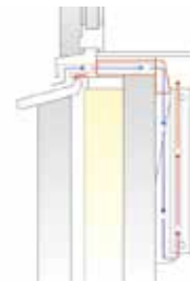
Luchttoevoer door onderdorpel van een houten kozijn
