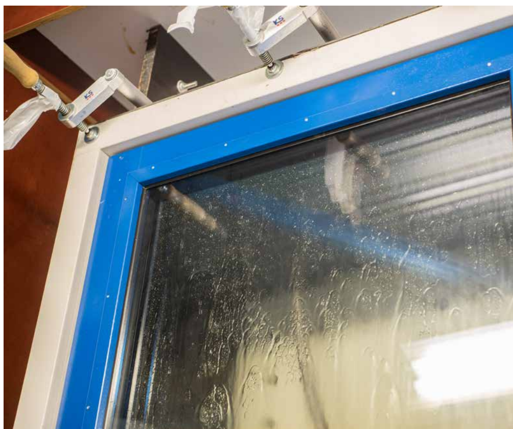
Opstelling wind- en waterdichtheidstest
